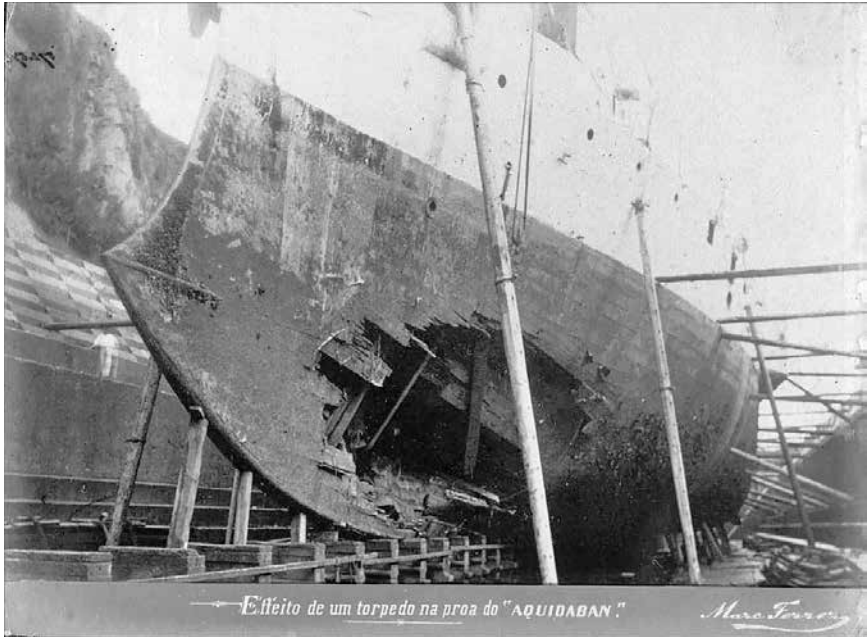
Figura 4 – Efeito de um torpedo na proa do “Aquidaban”
